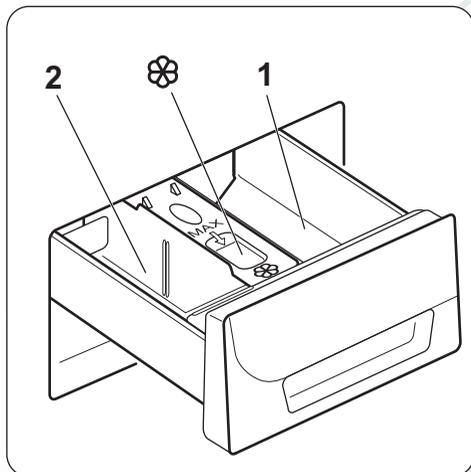
**1** Отделение дозатора моющих средств, предназначенное для этапа предварительной стирки или программы замачивания. Добавьте средство для предварительной стирки и замачивания до пуска программы.
