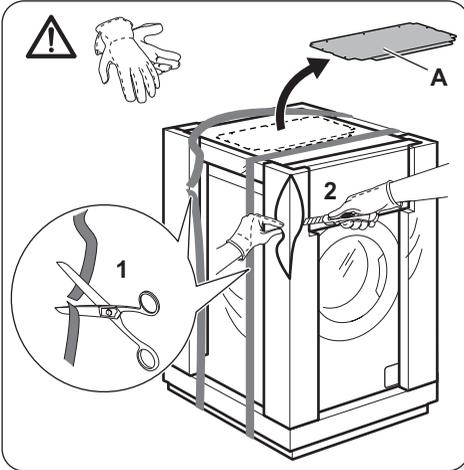
1. Используйте перчатки. Перережьте ножницами обвязочную ленту и снимите при помощи ножа закрывающую прибор пленку.
