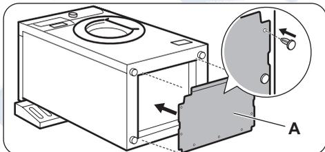
7. Зафиксируйте пластиковую крышку (А), снятую сверху во время распаковки, к дну прибора. Удалите липкую ленту и закройте дно прибора. Приделайте пластиковую крышку к дну прибора, зафиксировав ее маленькими пластиковыми заглушками из пакета с инструкцией по эксплуатации.
