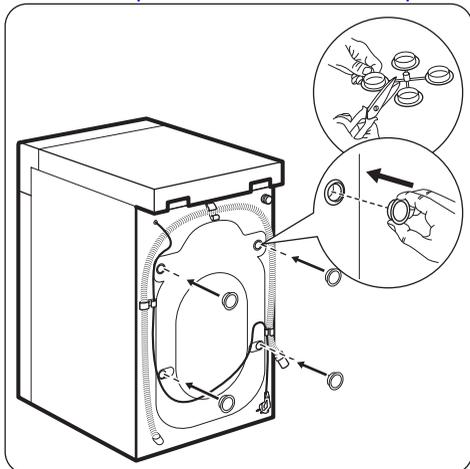
10. Вставьте в отверстия пластиковые заглушки. Заглушки находятся в пакете с инструкцией по эксплуатации.
