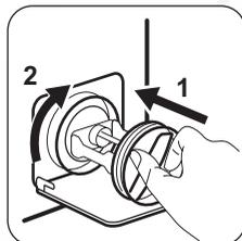
8. Очистите фильтр, находящийся под водопроводным вентилем, и вставьте его обратно в насос.
